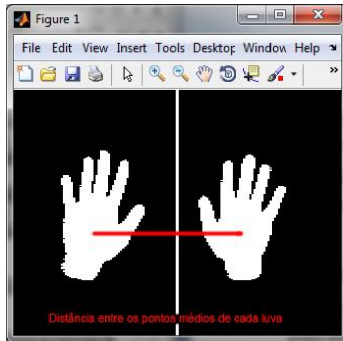
Figura 4.5: Cálculo da distância entre as luvas através de seus pontos médios.
